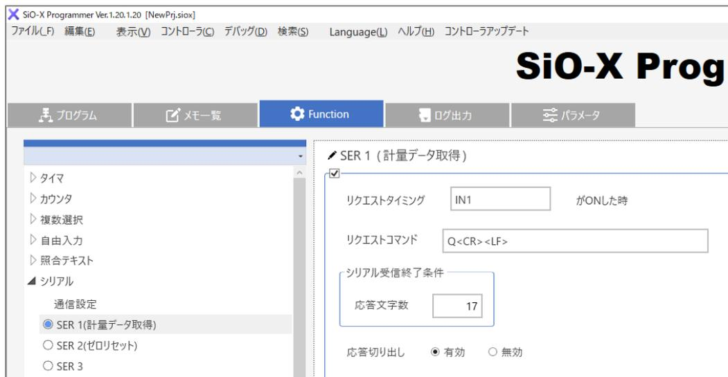
2. SiO-X Monitor の表示ファンクション(p.xx)で、SER1 の値を固定テキストに出力させるように設定します
